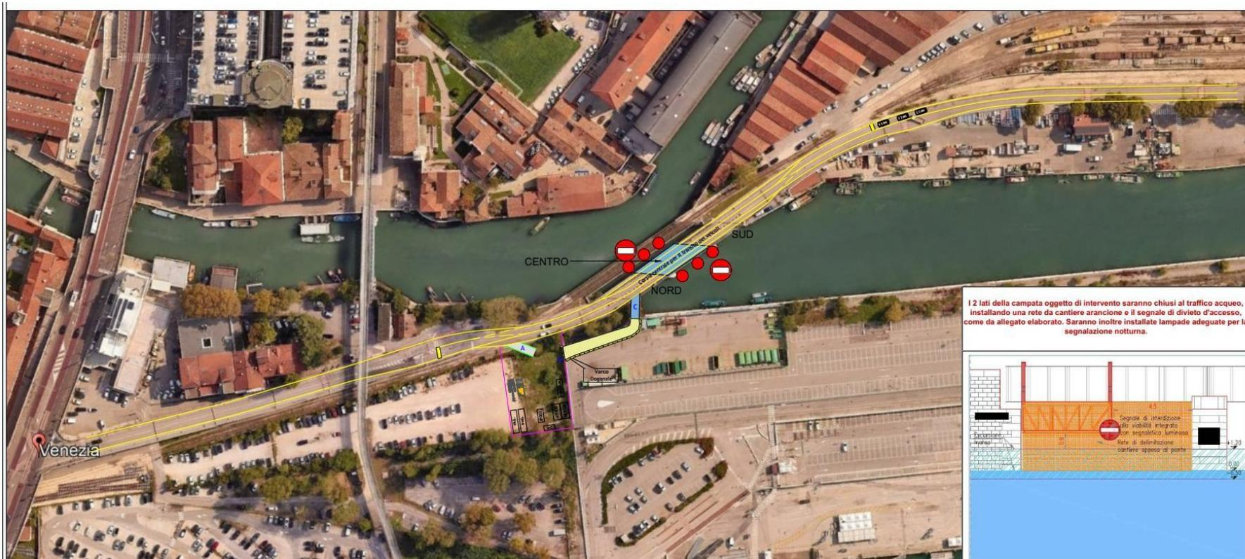
I 2 lati della campata oggetto di intervento saranno chiusi al traffico acquatico, installando una rete da cantiere arancione e il segnale di divieto d'accesso, come da allegato elaborato. Saranno inoltre installate lampade adeguate per la segnalazione notturna.
